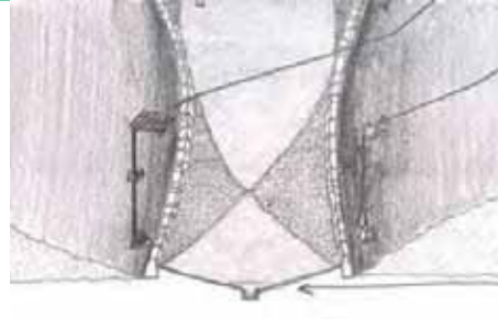
Croquis No. 46.- Vista parcial de Ecotecnia de captación de agua Pluvial en pasillos de parque, mediante un empedrado permeable y Dren captador y Ecotecnia de Luminaria Solar Autosuficiente.
