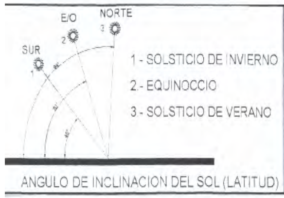
ANGULO DE INCLINACIÓN DEL SOL (LATITUD)
