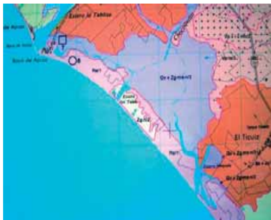
IMAGEN 38. Detalle de la carta edafológica con el área de estudio. Abreviaturas: Re, Regosol éutrico; Gv, Gleysol vértico; Zg, Solonchak gléyico. FUENTE: INEGI
