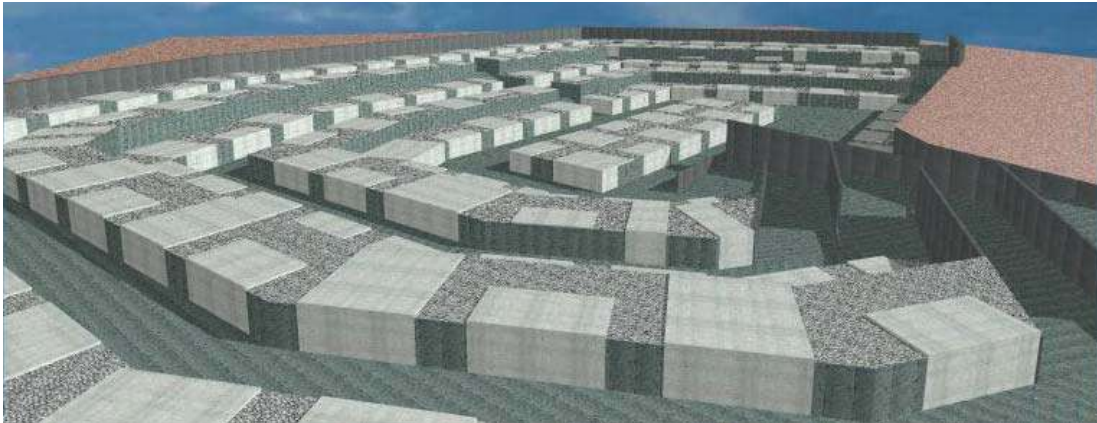
Parte central del área de gavetas donde se presenta un hundimiento.
