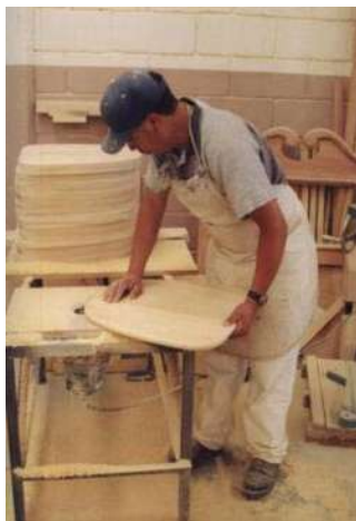
Foto No. 45 Fresado de piezas curvas. Fuente: Salvador Galinzoga.
