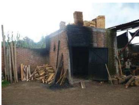
Foto No.38 Proceso rudimentario de secado inadecuado. Fuente: L. Manuel Galinzoga.
