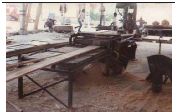
Foto No. 71 Desorillador de madera, corta tablones a diferentes anchos.
