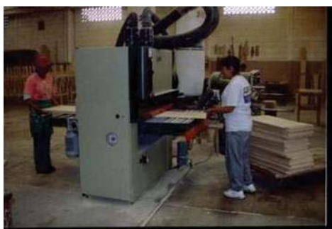
Foto No. 43 Calibradora, rectifica el espesor de las piezas mediante lijado. Fuente: Salvador Galinzoga.
