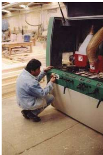
Foto No.44 Molduradora trabaja las cuatro caras de la madera en un solo paso. Fuente: Salvador Galinzoga.
