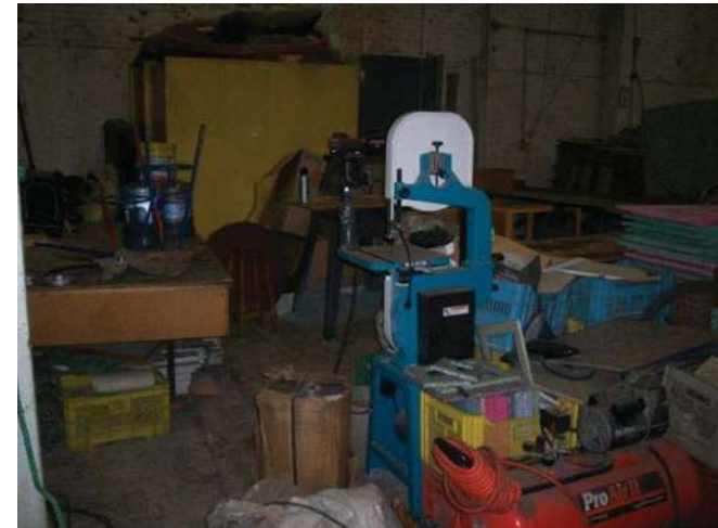
Imagen H).- En esta área se dedican a fabricar diferentes piezas, entre las cuales, y las que mas demanda tienen son butacas para escuelas, mesas y sillas, este material se trabaja como si fuera una tabla de madera, solo que el color no se le puede cambiar, la tabla se ve conformada de muchos puntos de colores, ya que los diferentes colores no se mezclan en la fundición.
