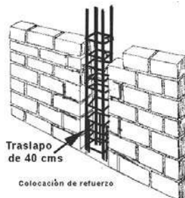
IMAGEN 59.- En esta imagen podemos observar el castillo armado, se traslapa 40 cm. para que quede fijo a la cimentación, después se cimbra y se vacía el concreto.
