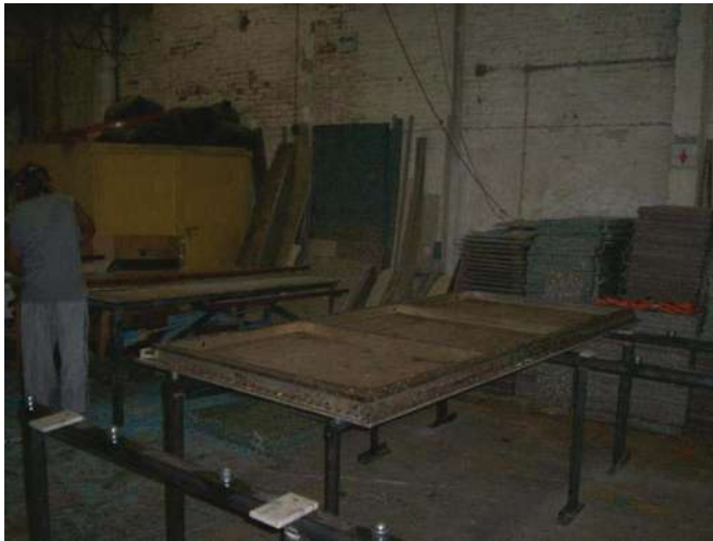
Imagen G).- Después del proceso de fundición se desmoldan las tablas, y se van apilando según el color del plástico, para que las tablas salgan de un color determinado, se trituran botellas de plástico de un mismo color, pero si el material triturado no viene separado por colores se funde así y se obtiene una tabla con una gran variedad de colores.
