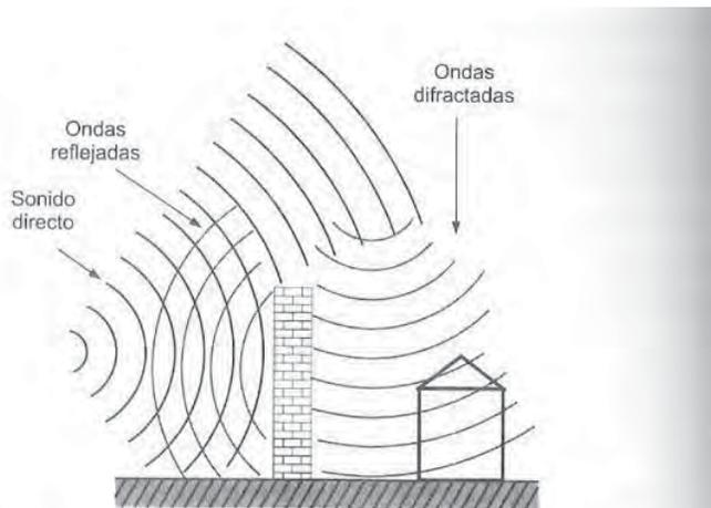
Fig. 2.62 Ejemplo de difracción del sonido alrededor de una barrera acústica instalada delante de una vivienda a modo de protección frente al ruido.
