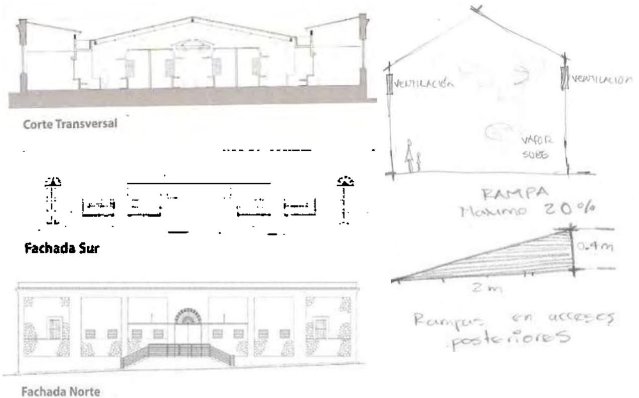
Un punto importante fue la rehabilitación de la fachada principal, restableciendo y reforzando la conexión visual entre las facilidades de la plaza y de la calle. Remodelación de capas de pintura de todas las fachadas de todos los exteriores dejando expuesta la piedra; creación de rampas y pintura en el concreto; así como, la creación de área para basura y desperdicios.
