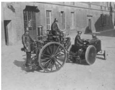
(Foto 5 Tractor Fordson, adquirido en 1923 en la casa Casajuana, arrastrando una bomba Flader (conocida como la Americana), adquirida en 1904)
