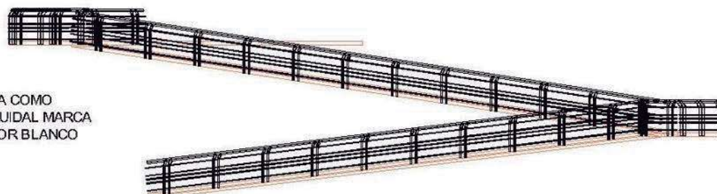
VISTA DE FRENTE DEL BARANDAL DE LA RAMPA
