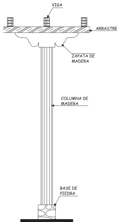
Figura 6. Columnilla de madera. Fuente: Material inédito realizado por el autor para el proyecto “Revaloración del patrimonio cultural edificado como elemento de identidad de las comunidades rurales del Estado de Michoacán”
