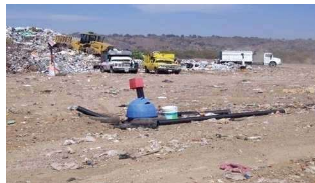
Figura 018. Este es uno de los pozos de venteo que se encuentran ubicados a 25 metros cada uno. Fotografía Violeta Constantino Ortiz
