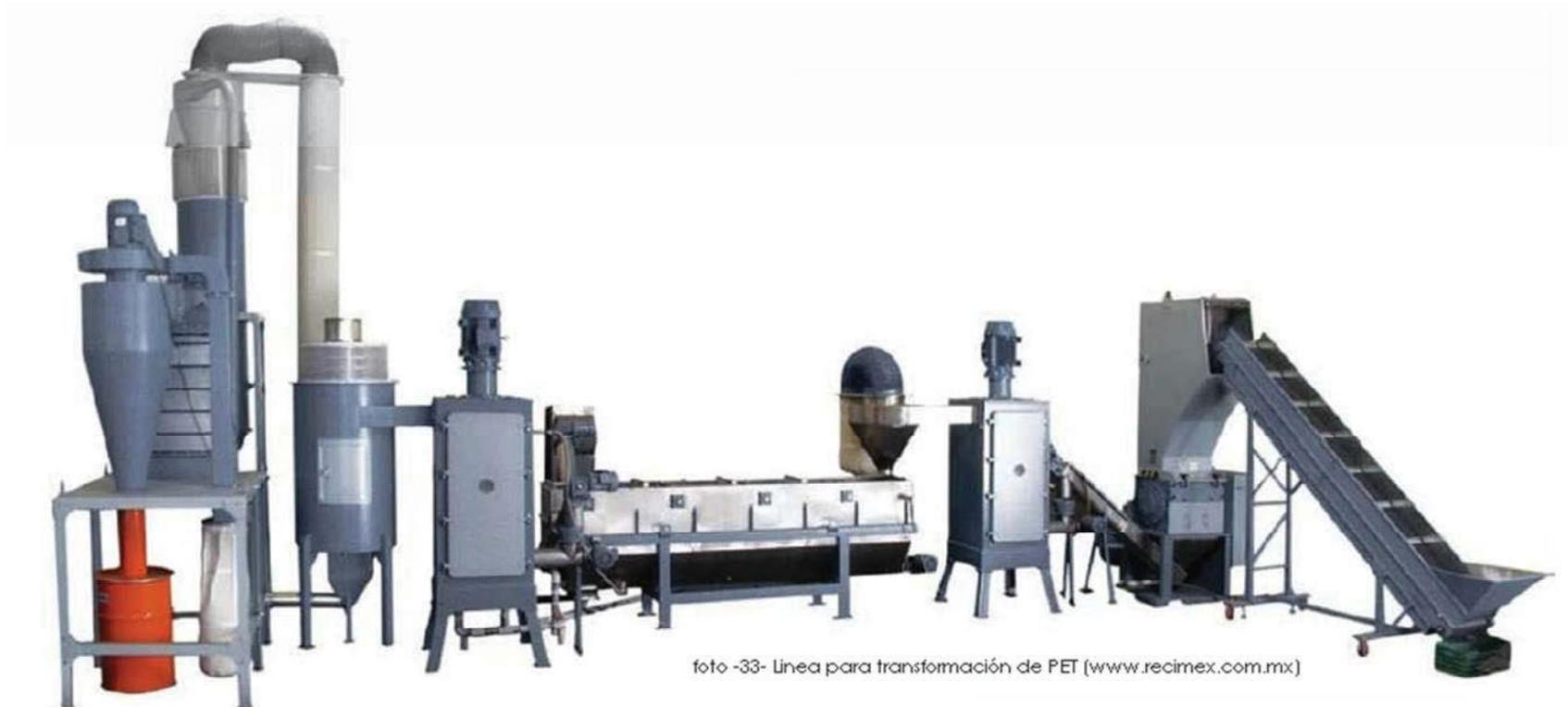
**Banda** inclinada de alimentación, **Molino** con inyección de agua, **Tornillo** sin fin para transportación de hojuelas y escurrimiento de agua residual, **Secadora** centrífuga tipo vertical, **Ciclón**, **Tanque** de separación por flotación, **Secadora** dinámica vertical, Extractor neumático, **Ciclón** y **Silo**, **Separador** de finos sobre estructura para llenado de supersacos.
