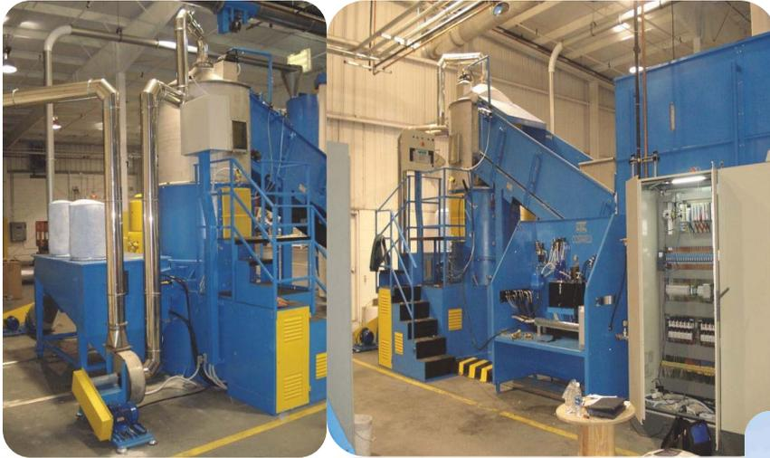
Imagen No. 10.- Densificador automático/dosificador, fuente: [www.navarini.com/agglomerator](http://www.navarini.com/agglomerator), septiembre 2009
