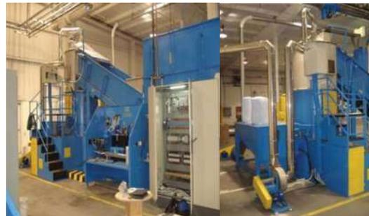
Imagen No. 10.- Densificador automático/dosificador, fuente: [www.navarini.com/agglomerator](http://www.navarini.com/agglomerator), septiembre 2009
