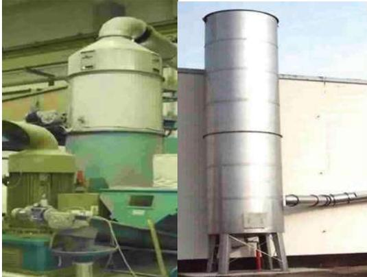
Imagen No. 11.- Tolva de aspiración/condensador, fuente: [www.navarini.com/agglomerator](http://www.navarini.com/agglomerator), septiembre 2009
