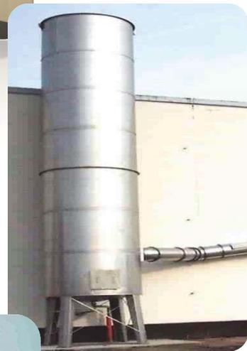
Imagen No. 11.- Tolva de aspiración/condensador, fuente: [www.navarini.com/agglomerator](http://www.navarini.com/agglomerator), septiembre 2009
