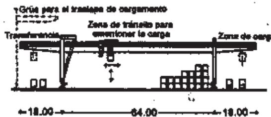
IMAGEN 69. GRÚA CORREDIZA PARA DIFERENTES CONTENEDORES Y GRÚA DE ALIMENTACIÓN DE CARGA.
