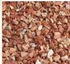
Imagen 11. Grava obtenida de la trituración de rocas, considerada agregado grueso dentro del ámbito de construcción, FUENTE; Google.com
