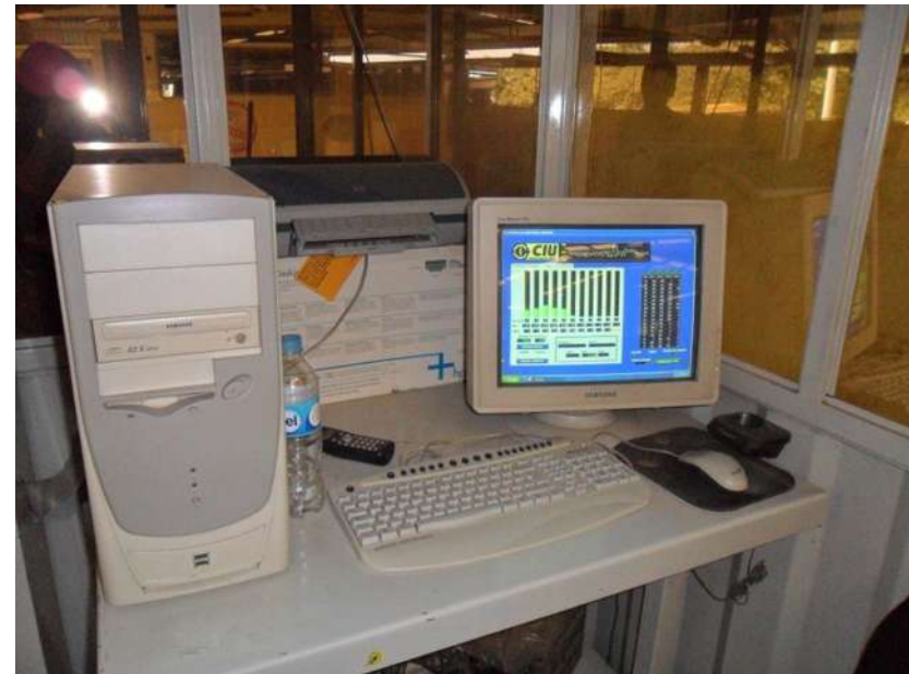
7.1) Imagen de la cabina de control de la empacadora Hassby, el sistema marca cada uno de los aguacates, su calibre y peso dando resultados por segundo de la producción.
