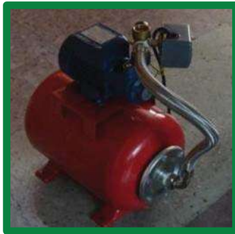
Imagen 85. Hidroneumático de 126 V. ½ HP
