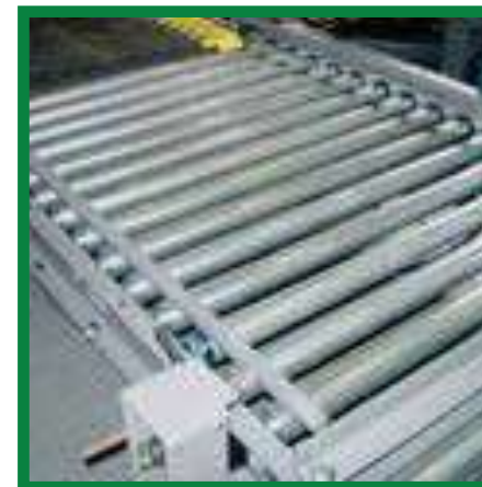
imagen 83. Muestra el sistema de rodillos con el que trabaja para mover los objetos.
