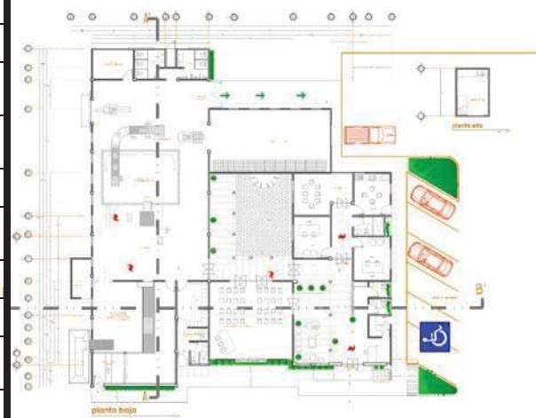
Croquis 3, Imagen 21. Creada por VMMG. Esta imagen muestra la planta arquitectónica de la bioplanta de Producción de Micorrizas en Zacán, y los espacios que la integran en relación con la información de las filas de la izq.
