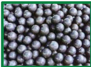
Imagen 81. Imagen que muestra la forma de las bolas de acero que integran el interior del molino.
