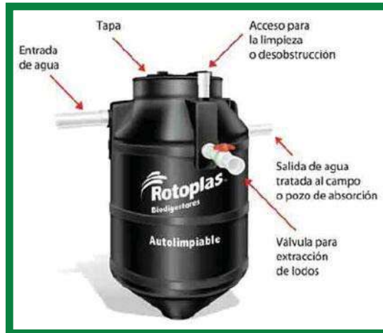
Imagen 77. Proporcionada por, Rotoplas, creada por VMMG. En esta imagen se muestran las partes externas que componen las fosas sépticas.
