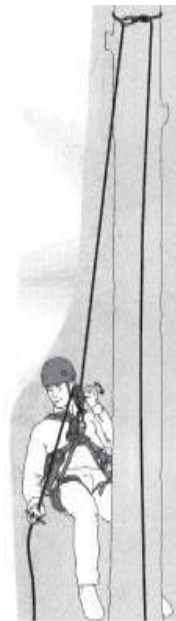
Fig. 1: El mosquetón (de seguridad) unido a una pegueña gaza estrangula la cuerda en el anclaje (en este caso un árbol) e impide que mueva.
