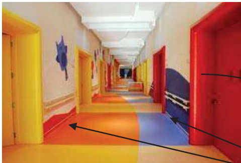
Figura No. 87 Existe la circulación lineal dentro del edificio, con accesos en ambos costados, iluminación empotrada en el plafón, variación de las alturas de los plafones para las diferentes áreas así como entre pasillos y vestíbulos.
