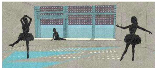
Imagen. 81. Sketch del salón de danza para probar el juego de luces y sombras que se genera con el panel perforado de la fachada.
