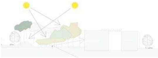
**IMAGEN\_41** Ejemplo de análisis de asoleamiento, esto con el fin de poder dar una correcta orientación o alguna solución al mismo.
