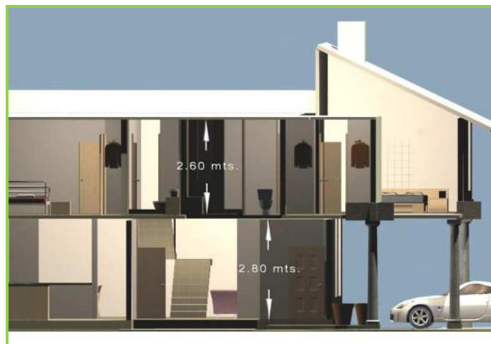
Imagen 38. Empleo de la altura en una Casa habitación FUENTE: Energía solar en arquitectura y en construcción 105
