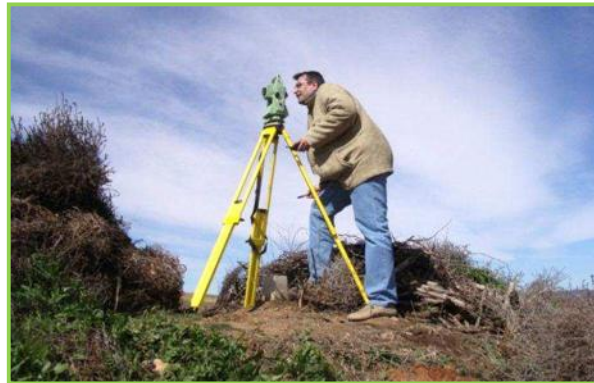
Imagen 29. Realización de un levantamiento topográfico mediante el empleo de la Estación Total FUENTE: Marcos Sánchez Omar 95
