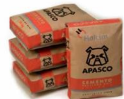
Imagen 3._ Cemento Normal Tipo I. Este aglutinante puede ser apasco o similar. Este nos servirá para colar cimentación, castillos, dalas, firmes y losas. Resistencia según proyecto.
