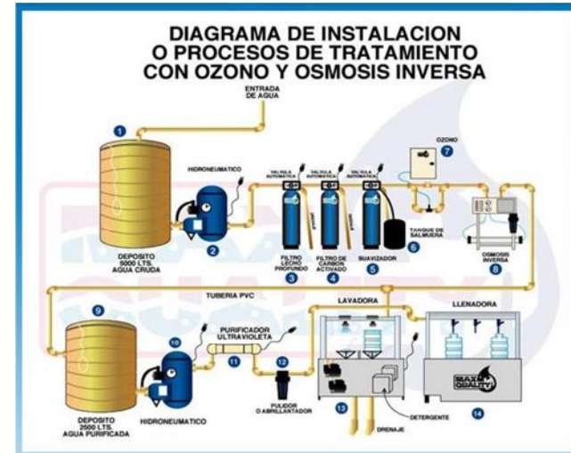
Imagen 72/tratamientos con ozono y osmosis inversa / http://www.plantaspurificadorasdeagua.net/purificadoras_de_agua/4_purificadoras_de_agua.html / 2010
