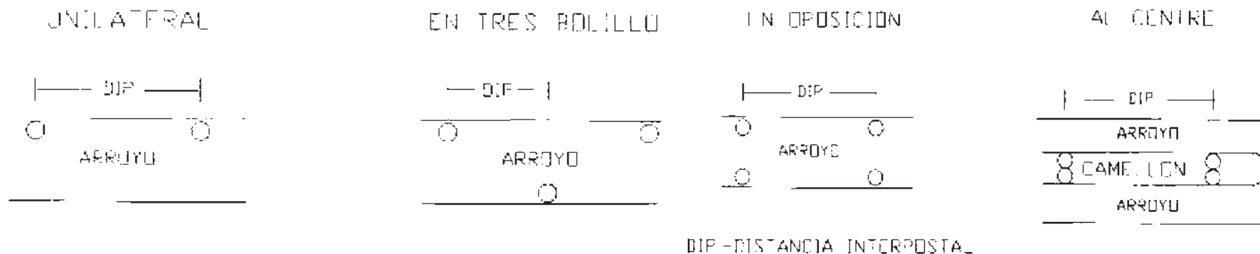
Figura 67. DISTRIBUCIÓN INTERPOSTAL PARA ALUMBRADO PÚBLICO.
