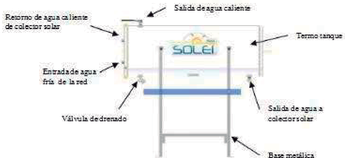
Figura 85. FUNCIONAMIENTO DEL TERMOTANQUE. Fuente: Manual general de instalación y mantenimiento para el sistema solar de calentamiento de agua. http://es.scribd.com/doc/73534530/CINSA-Sol-1 , p.4 [15-mayo -2012]
