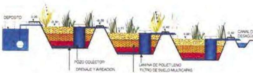
Imagen 85. Esquema de funcionamiento del humedal de tratamiento. Fuente Guía para el diseño de servicios turísticos básicos en sitios naturales
