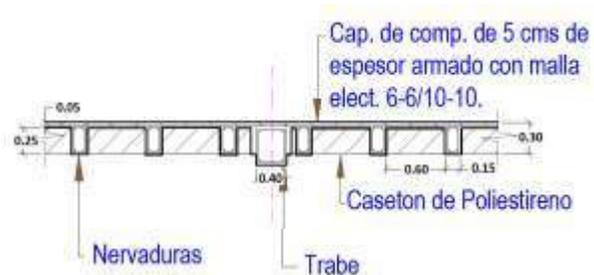
Imagen No. 97: Corte de losa reticular de casetón de poliestireno.
