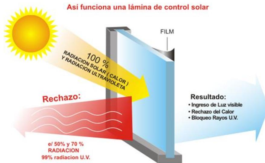
Ilustración 29 Función de lámina de control solar. Fuente en Línea:
