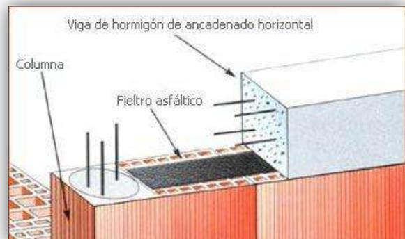
Imagen 25 Confinamiento. Fuente: <http://www.ceramicaraja.com.ar/ficha1-muros.htm>
