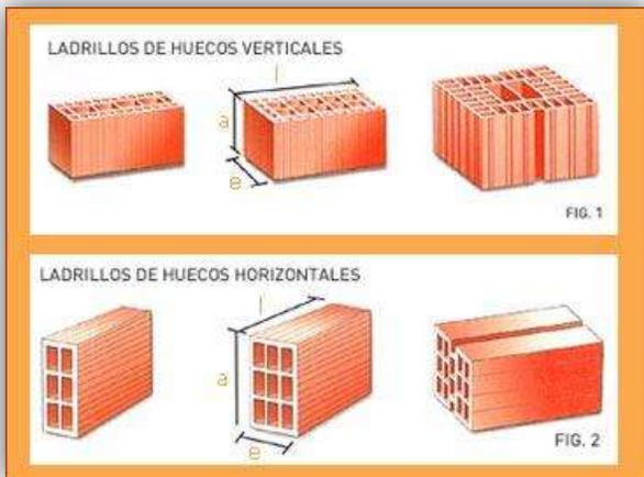
Imagen 24 Ladrillos huecos. Fuente: <http://www.ceramicaraja.com.ar/ficha1-muros.htm>
