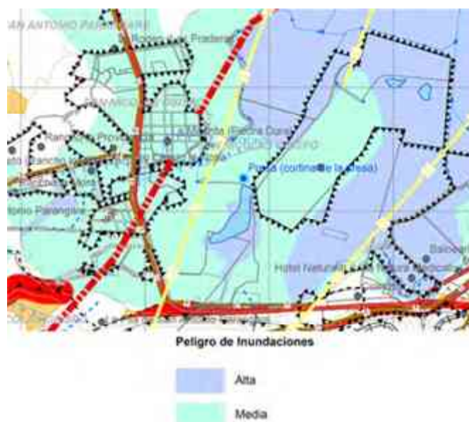
Imagen 3.38. Afectaciones por riesgo de inundación. Imagen obtenida del Programa de Desarrollo Urbano del Centro de Población de Morelia 2010.
