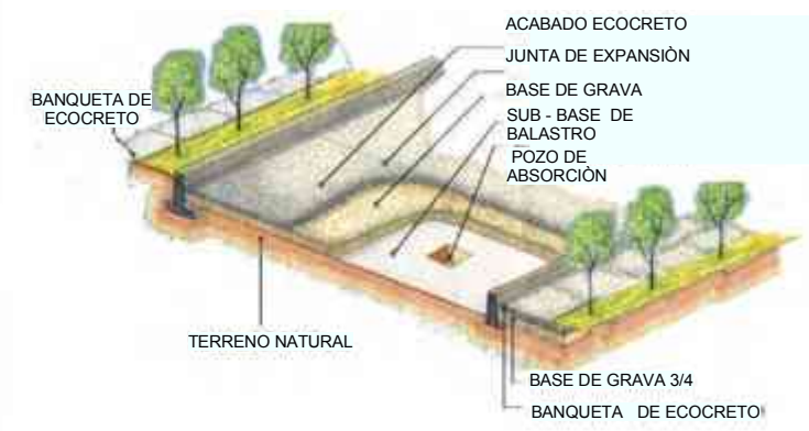
2 SECCIÓN TIPO SISTEMA ECOCRETO PA101 S/E
