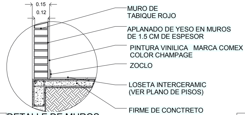
3 DETALLE DE MUROS AB101 | S/E
