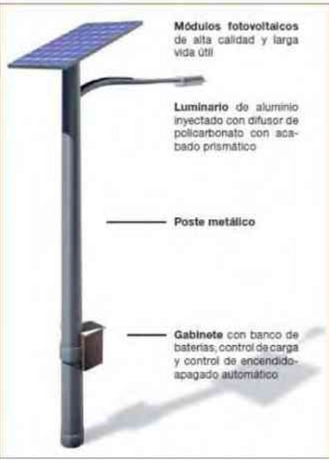
DETALLE 2 LUMINARIA SOLAR
