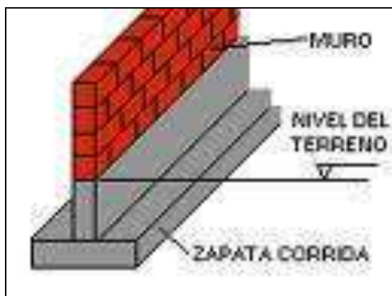
Imagen 55. Zapata corrida bajo muro
