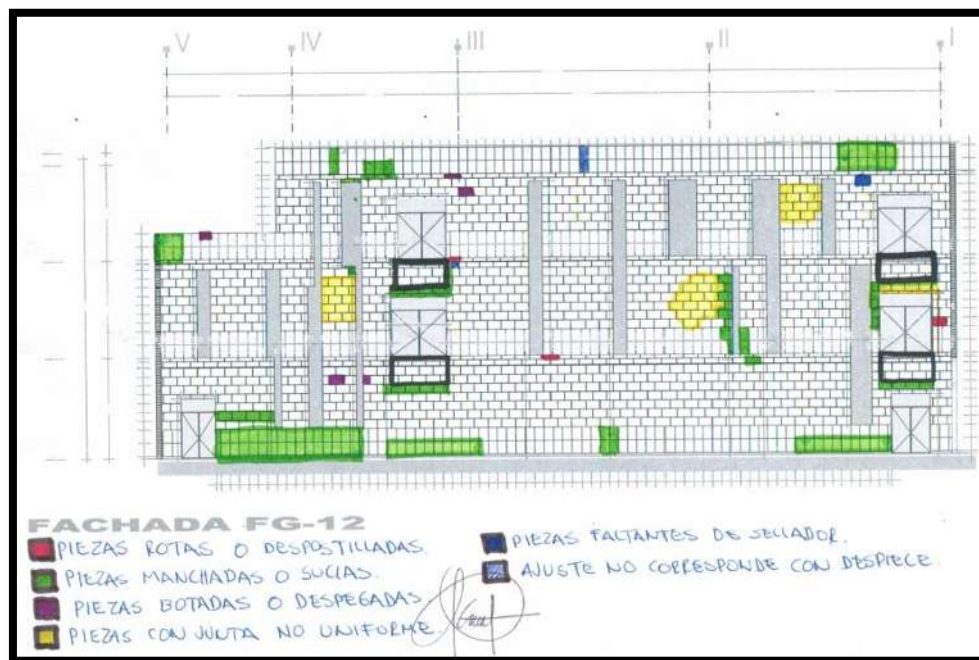
Figura 077. Imagen de Levantamiento de Colocación de Recubrimiento de Canteras en Fachadas del Módulo de Medicina Física. Fuente: Víctor Hugo Servín Fuentes. [2012]
