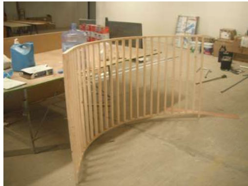
IMAGEN 146 Bastidor de mueble curvo de recepción. P.B.
