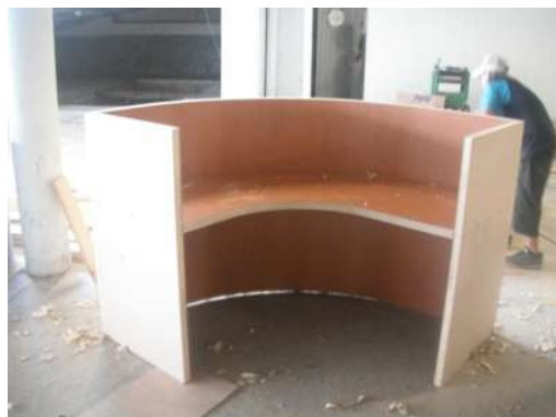
IMAGEN 148 Colocación de laminado plástico en mueble curvo de recepción. P.B.
