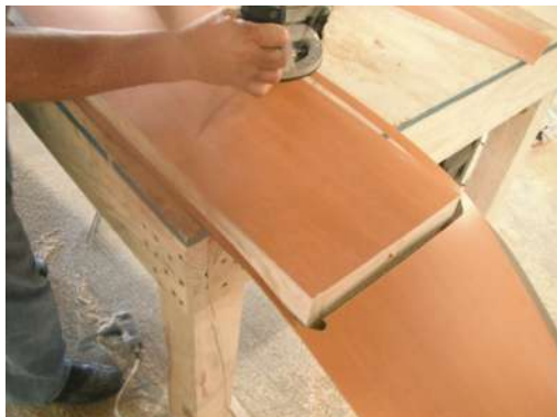
IMAGEN 110 Retiro de exceso de laminado plástico con Reuter. P.B, 1°, 2°, 3er nivel
