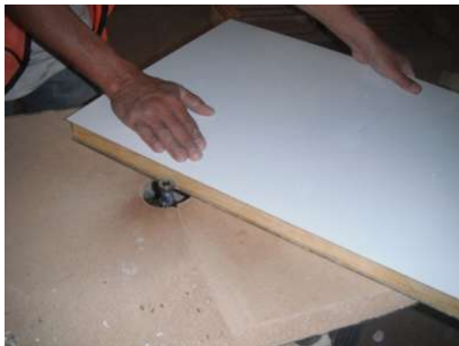
IMAGEN 128 Retiro de excedentes de laminado plástico. P.B, 1°, 2°, 3er nivel
