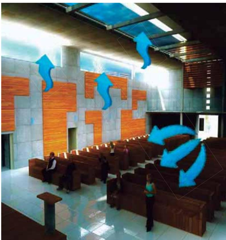
Figura 6.13 Iluminación y ventilación en el proyecto..
