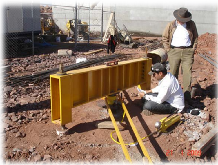
Imagen 31 Pruebas de capacidad de carga aplicada al suelo. http://www.inglaner.com/preliminares_llao.htm Enero 2013
