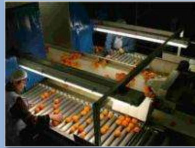
Imagen 50.- Selección del Producto por medio de Bandas Transportadoras
