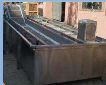
Imagen 51.- Tanque de Agua Fría para Sustraer pulpa.
