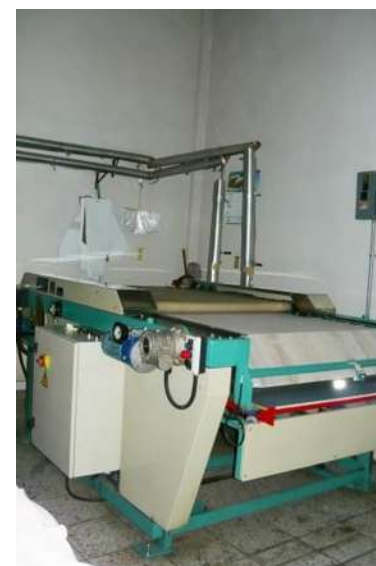
Imagen 13: Plancha de vapor para lienzo utilizada en taller de suéter en Moroleón.
