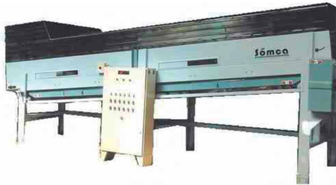
Imagen 13 – “TUNEL DE SECADO”, RAMOS TALLERES & MAQUINARÍA, 12530 Burriana (Castellón), España
