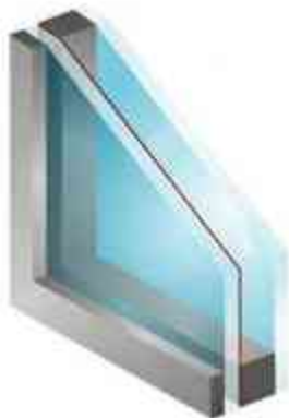
Imagen 48. Uso de cristales dobles en edificio administrativo.
