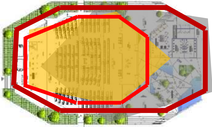
Imagen114. Superposición de figuras básicas que generan la forma de la planta del auditorio. Fuente: GuiCast, planimetría del proyecto, auditorio.
