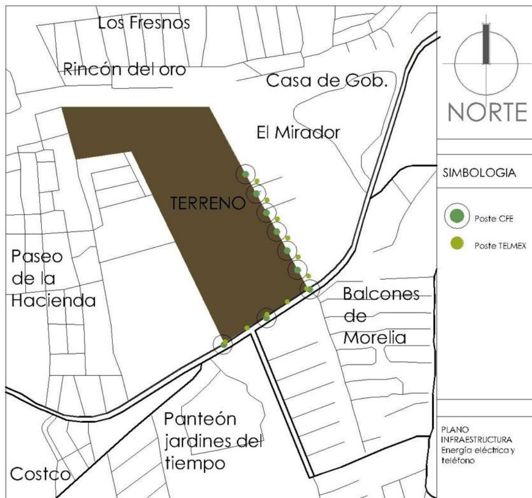
Ilustración 47 PLANO DE INFRAESTRUCTURA ENERGÍA ELÉCTRICA Y TELÉFONO. FUENTE: AUTORES
