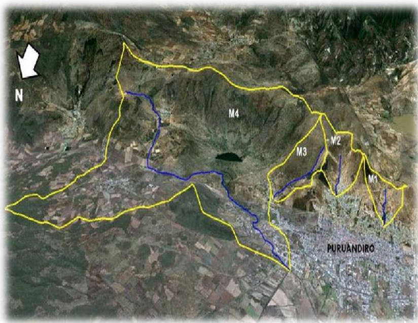
IMAGEN 57: En la siguiente imagen se observan los parte aguas y los cauces principales de cada micro cuenca. Fuente: atlas de riego se
