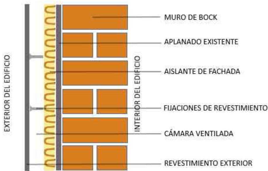
Img 95. Esquema de fachadas ventiladas
