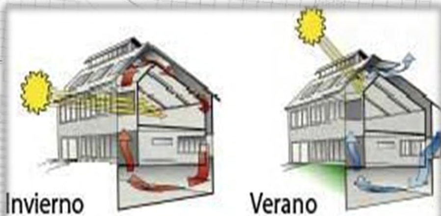
Imagen 35.-Sistemas pasivos, captación de la radiación solar. http://ocw.unia.es/ciencias-artes-y-letras/sostenibilidad-y-arquitectura-bioclimatica/contenidos-materiales-html/UD_03/ud-3-sistemas-pasivos-y-sistemas-activos-de
