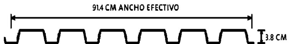
Imagen 40 de corte de lámina galvanizada de la marca galvadeck<sup>9</sup>
