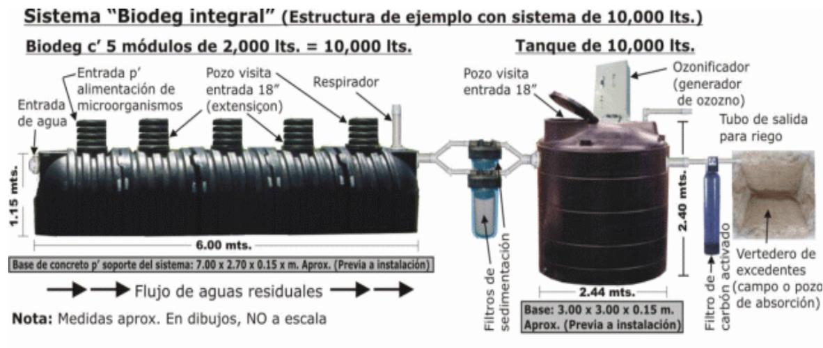
Imagen 59 Funcionamiento del sistema biodeg
