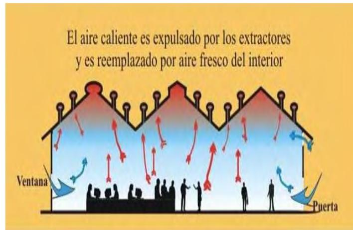
Imagen 47 del ciclo del aire producido por un extractor<sup>18</sup>
