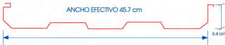
Imagen 38 de un corte de una lámina galvanizada
