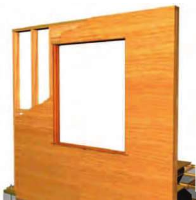
Fig. 94, Tablero soportante de madera prefabricado (interior), Fuente "La Construcción de Viviendas en Madera", p. 214
