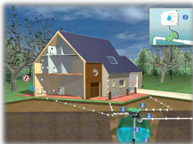
Imagen 46 Captación de agua pluvial. Fuente: http://www.google.com
