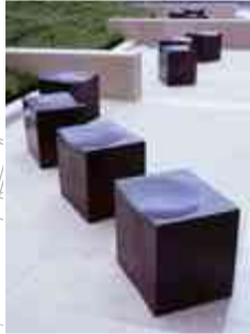
Banco de 50x50 cm formada con concreto recubierta de madera tropical de 0.04 x 0.05 m tratada especialmente para uso en exteriores.
